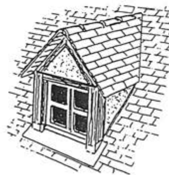
Lucarne en bâtière.
